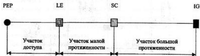
Рис. 1.2. Схема национального участка гипотетического эталонного тракта по рекомендации F.1703[5]: LE – местная АТС; SC – сетевой узел коммутации (первичный, вторичный или третичный)
