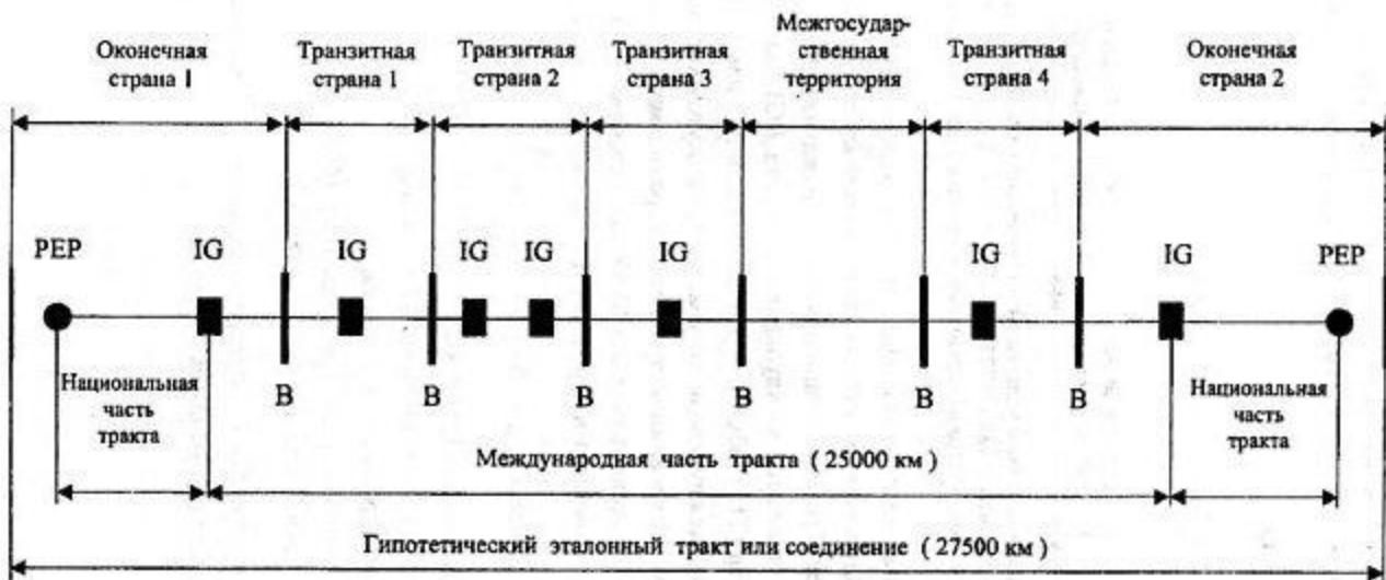
Рис. 1.1. Схема гипотетического эталонного тракта или соединения по рекомендации G.826 (PEP – окончательный пункт; IG – международные ворота; В – государственная граница)
